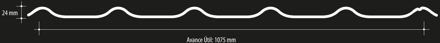
Teja Continua Curva, es una cubierta habitacional de acero de largo continuo, con claras ventajas estructurales y de estanqueidad. Su sistema de traslape lateral corta la filtración de agua por capilaridad.
